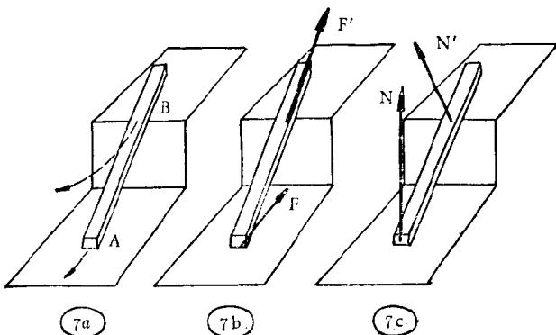
假设有一条木条, 它的一端搁在毛糙的地板上, 另外一端搁在粗糙的台阶上。如图 7 所示:
