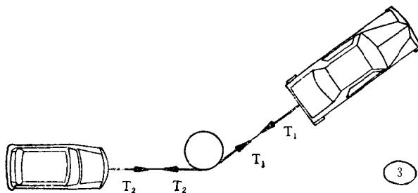
**14. 滑轮组** 一个障碍物的“摩擦”或“粗糙度”会导致作用力的损失。如果障碍物是光滑的，那么就不存在作用力的损失，因此绳子两笔直部分上的力是完全相等的。一根跨过无摩擦滑轮的绳子，就是如此的情况。
