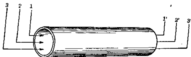
圖1 多波型波導傳輸的示意圖
