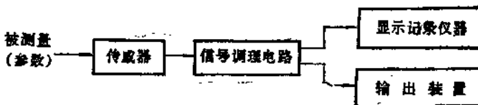
图1-1 模拟式测量系统组成原理
