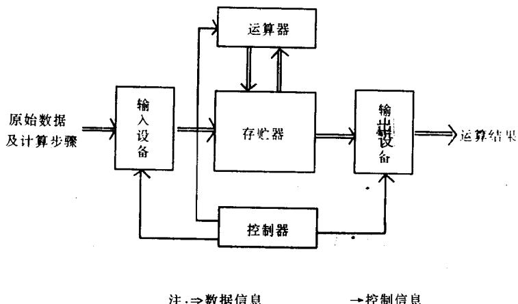
中央处理机包括运算器和控制器两大部分。运算器负责对数据信息进行加工,实现算术运算、逻辑运算及信息传递;控制器是全机的指挥中心,负责对指令进行分析,向各部分发出控制信号,按一定的时序,协调各部分工作。
