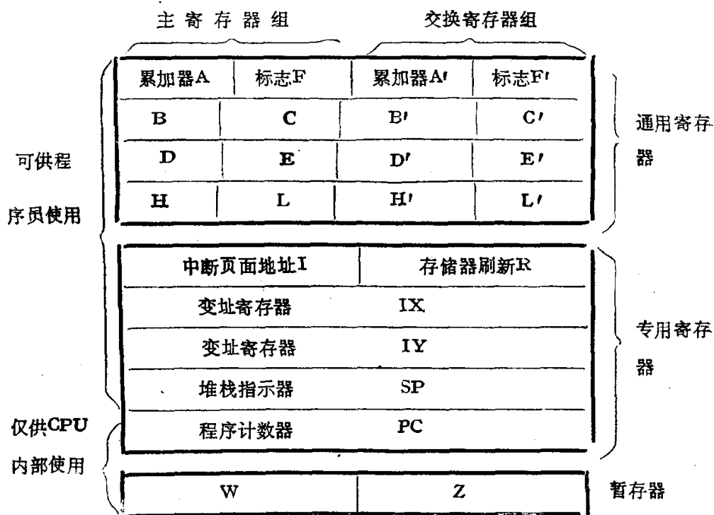
图 1-3 Z80-CPU寄存器结构
