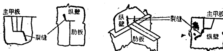
图 1-3 浙海 403 号上结构破坏的例子
