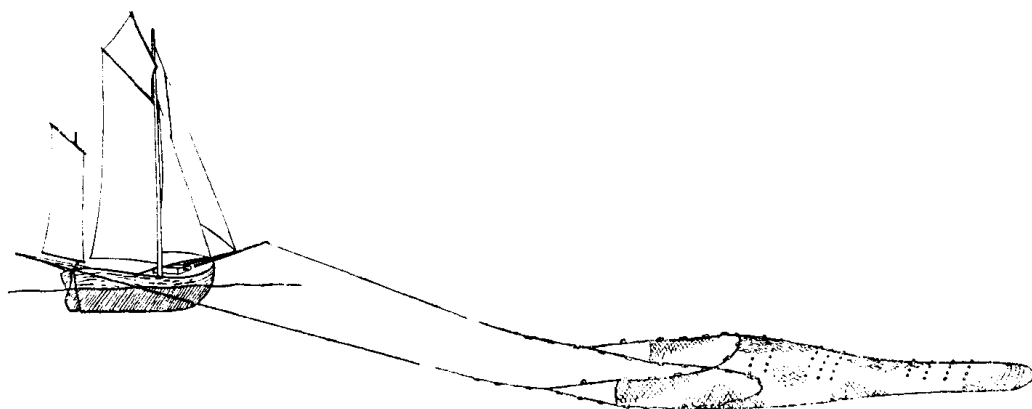
图4 当单桅帆船横拖时，利用船首、尾部装置的弦杆水平张网
