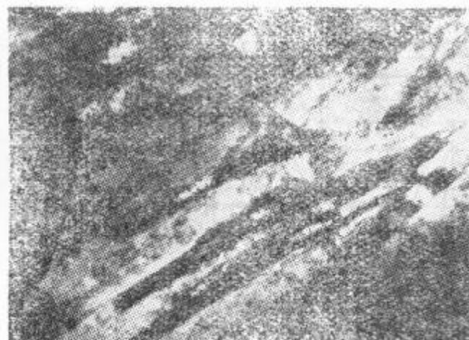
图 1.9 冷加工后铁素体中的位错结构( \times 25000 )
