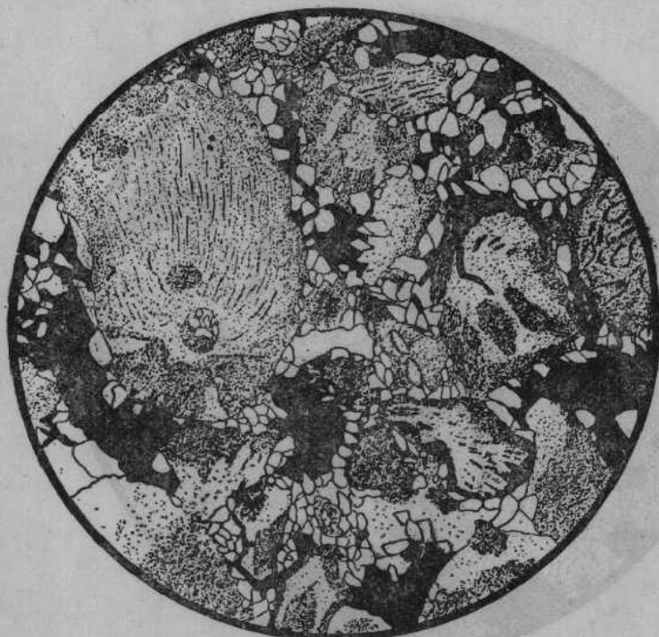
图8 具有细孔隙的第二类型孔隙空间构造。采自伊希姆拜区东部大块下二叠系阿尔丁斯克阶 ( P_1^a ); 碎屑, 海百合-苔藓虫灰岩, k = 230 毫达西, \times 42^{[11]} , 284 页。
