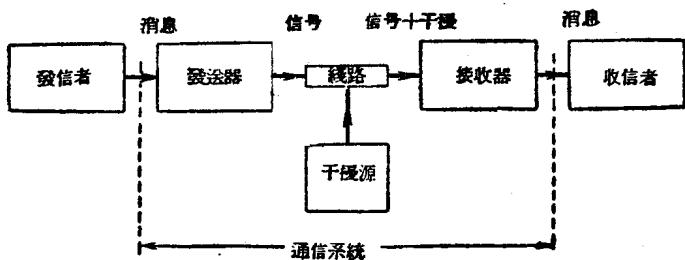
圖 1. 通信系統方框圖
