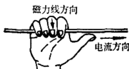
图 2—2 通电导线的磁力线方向
