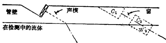
图 1e 左边是装在管壁内折射声楔，右面是由外空腔 C_1 加内腔 C_2 或具有平行面的声楔 W_2 在管壁内构成不折射窗孔
