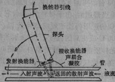
图 1g 测量流量或马赫数 v/c 用的多普勒流量计, 用于测量丙烯酸管道内流动的液态金属 Hg 和 NaK; 其内径为 0.476 厘米; 发射频率约 10 兆赫; 平均流速约为 1~5 厘米/秒 (Fewlis, 1973)
