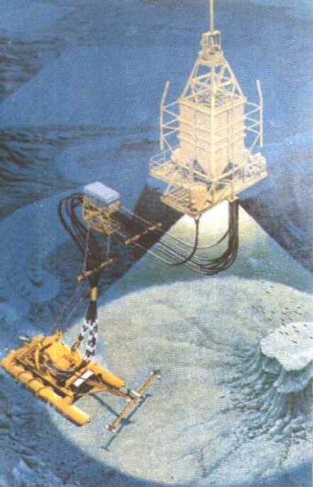
12 采集海底锰结核的成套原型设备。
