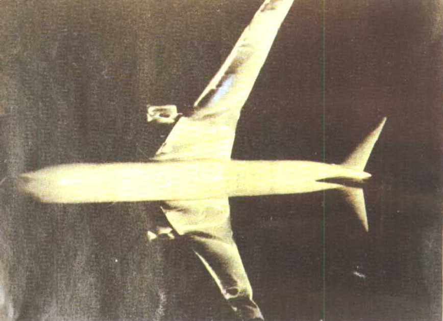
21 波音767客机模型涂了油层在风洞中用紫外线显示空气流动的情况。
