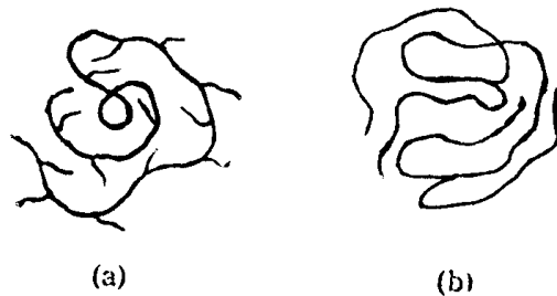
图 1-4 高分子链中的短支链(a)和长支链(b)
