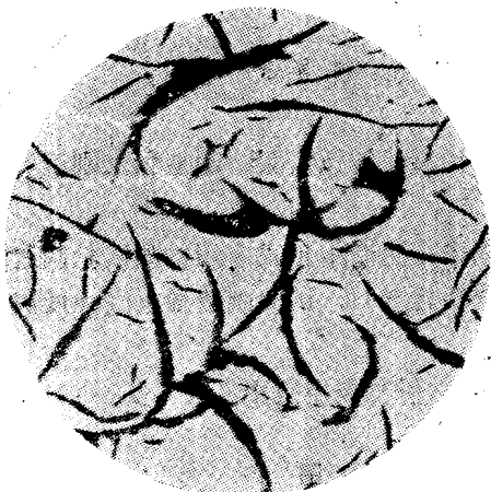
图1-1 粗片状石墨,原铁水未加稀土,100×
