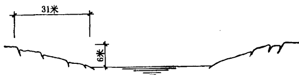
图 13 胜利桥附近河岸滑坡断面示意
