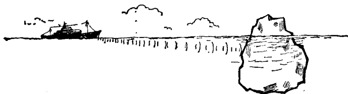
图 6 利用声波探测冰山
