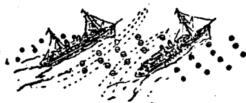
图 5. a 流过两艘靠得很近的船只的水的流速，在两船之間比外面快，因此，两船間水的静压力比外面小
