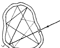
图1-2 物体内的空腔靠物体上的一个小洞与外界相通。射在小洞上的辐射经过空腔内表面接连多次反射后,就完全被吸收了。因此,小洞的吸收作用同黑体相似。在逆过程中,从小洞发出的辐射是由内表面发出的各个组分组成的,这时小洞的发射作用也同黑体相似。
