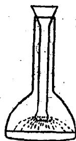
图 2-6 用长颈漏斗注入
