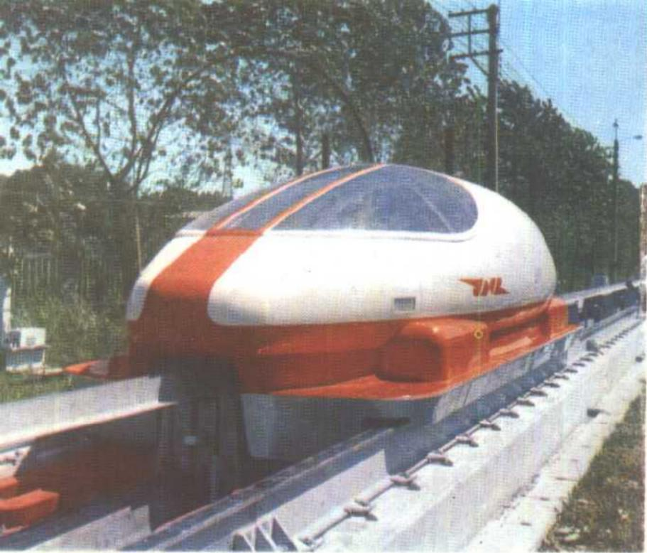
上图：日本国营铁道公司正在研制的直线电动机车的实验车。该公司技术研究所正在以时速四百公里为目标开展研究工作。
