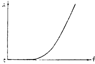
图 2-2 一个低通滤波器的衰减特性
