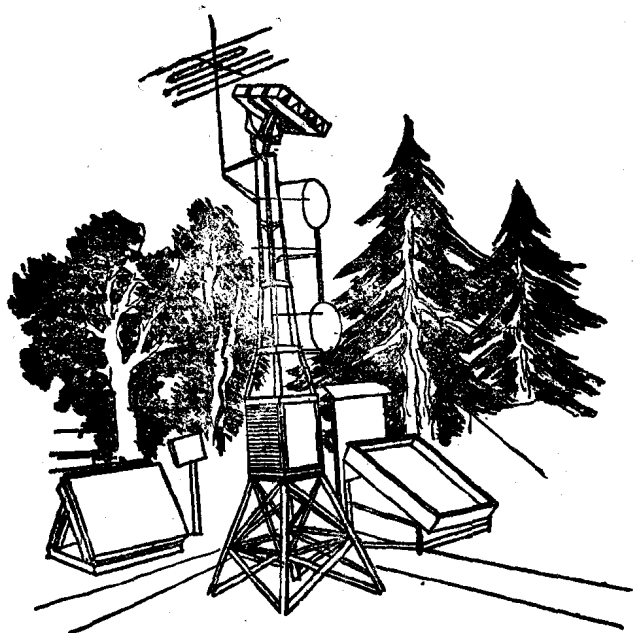
图1-9 太阳能电池供电的电视差转机
