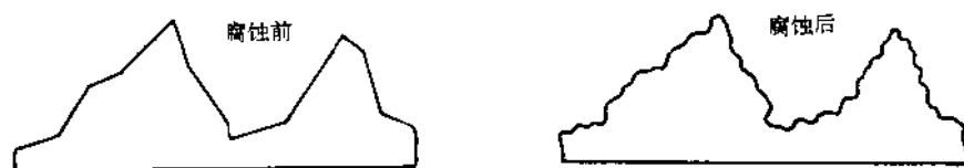
图 2-1 经过腐蚀处理和未经过腐蚀处理的砂目状态
