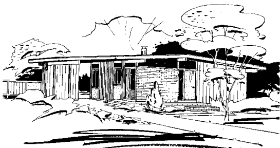
图 1-15 利用高反差的明暗关系来表现空间关系，必须控制黑色块面的大小和疏密
