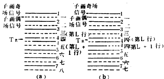
图 1—17 读出追上写入时的校正方法
