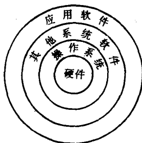
图 1-4 硬件和软件之间的层次关系
