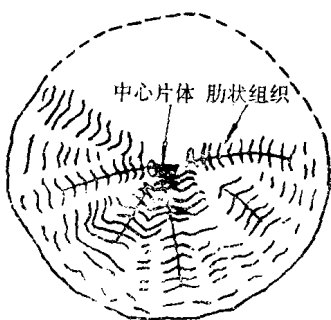
图 1-6 球状石墨结构示意图
