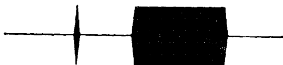
(b)信号(a)调制副载波到100%深度
