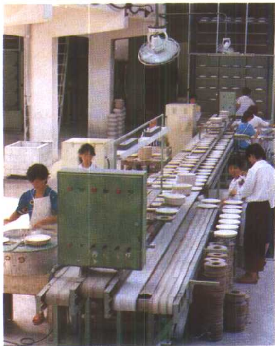
现景德镇宇宙瓷厂二车间链式干燥生产线。
