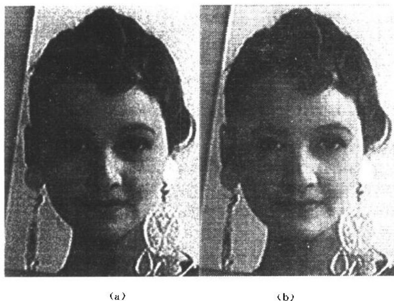
图 1.15 用 300dpi 喷墨打印机输出的抖动图象 (a)误差扩散抖动 (b)45°汇聚点的序抖动
