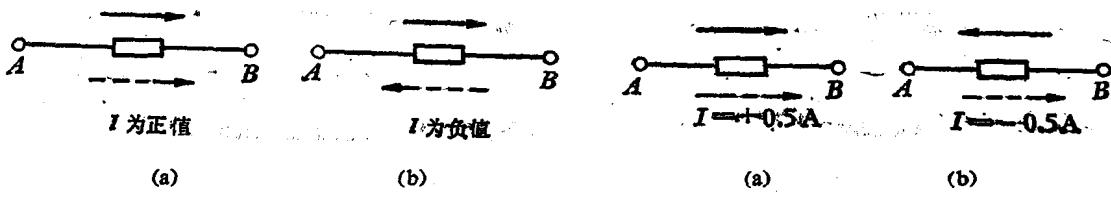
图 1-4 电流的正方向
