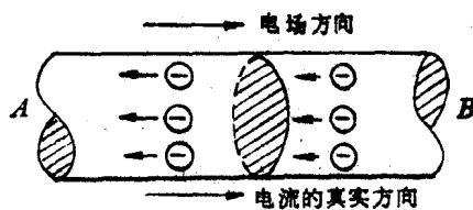
图 1-2 电流的真实方向
