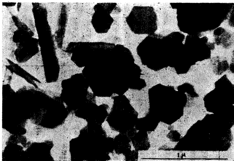
图 1-1-1 苏州阳西高岭石的电子显微镜图片
