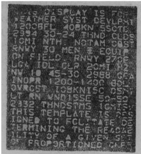
图2 在0.1毫米厚的金属薄膜上用电子束铣成的字母;字母长0.4毫米,笔划宽度70微米,用 Hamilton 标准型飞点扫描器控制射线
