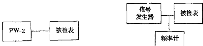
a) PW-2型外差频率计检频率刻度 (b) 计数式频率计检频率刻度
