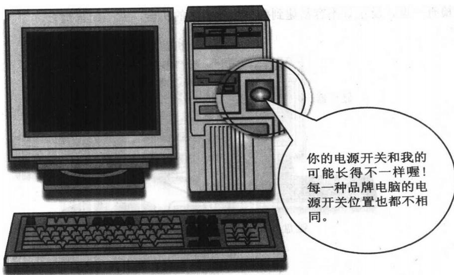
2. 如果你已开启了电脑电源开关，可是电脑却没有反应。遇到这种情形，首先先检查家里的电源插座是否有效，看看电源插座开关有没有打开，接着再检查电脑的电源连接线有没有松脱。若一切就绪，重新开启电脑电源开关，你应该会听到一声短哔声，否则就赶紧与购买厂商联络了。
