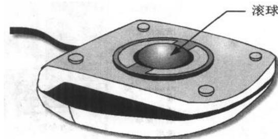
鼠标滚球位于鼠标的底部；它是一颗球状物。借滚球的滚动，碰触位于滚球室边的感知器（Sensor），再将收到的位移值传回电脑，换算成显示屏幕上的座标，就变成你看到的鼠标指针。
