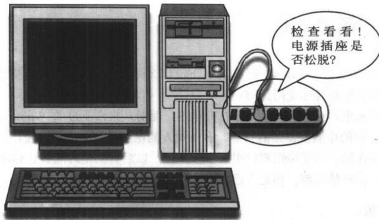
3. 如果，2步骤操作后，虽有短哔声，显示幕却没有画面出现，你最好是检查一下显示器与电脑之间的数据传输线有没有接好（有些高画质的显示器还有独立的电源连接线）。若方便的话，最好是连键盘、鼠标、打印机、调制解调器等外部装置与电脑之间的连接线一起检查一遍，反正好不容易逮到翻到电脑背面的机会，就一起来检查。
