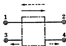
图 1.5 方向耦合器的示意图
