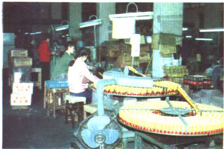
梧州市电池厂合营后经过技术革新、改造,至1985年建成9条整体生产流水作业线,具备了年产电池1.5亿只的生产能力。图为新华牌大号电池生产机械化流水线一角。
