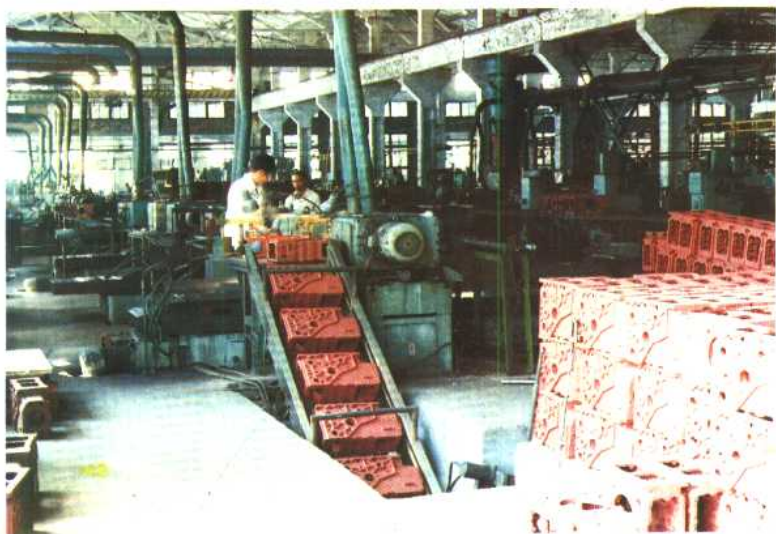
1958 年，公私合营铁工厂转为国营企业，更名 为南宁机械厂。现为国家机械电子工业部的重点厂 之一。图为柴油机缸体加工流水线。
