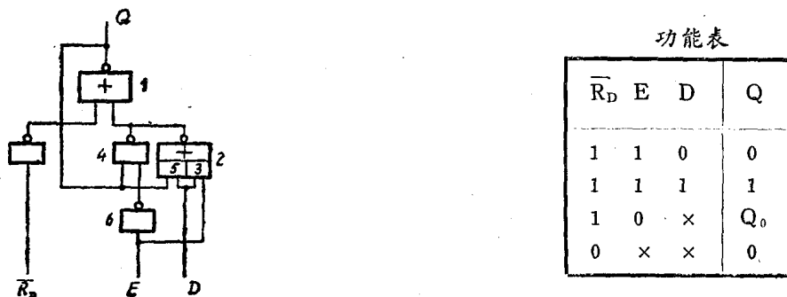
图 1-11 具有清零功能的锁定触发器的逻辑图
