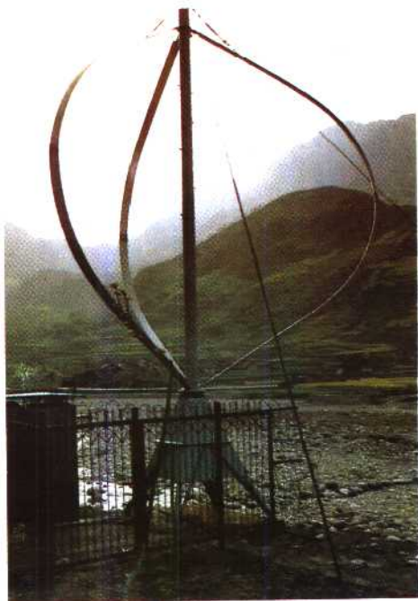
图4-7 6米垂直轴2千瓦 风力发电机▷
