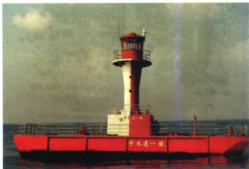
图6-8 中水道一号航标灯 波力发电船
