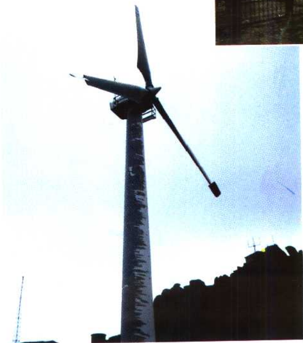
◁图 4-5 200 千瓦 水平轴风力发电机
