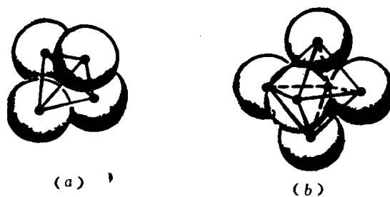
图 1-12 四面体空隙(a)和八面体空隙(b)的组成
