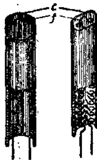
图1-3 间热式阴极的结构。
