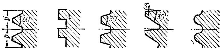
a) 三角形螺纹 b) 矩形螺纹 c) 梯形螺纹 d) 锯齿形螺纹 e) 半圆形螺纹
