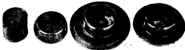
图 1-18 自行车花盘的冷模锻 自左至右：断料毛坯；压平；冷模锻；切边
