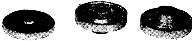
图 1-4 冷挤压纯铝绳轮 左——毛坯；中、右——挤压件的正反面
