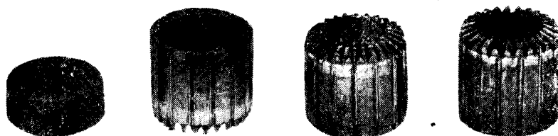
图 1-2 冷挤压低碳钢钻床夹头 左——毛坯；当中两件——冷挤件的正反面；右——冲孔后钻床夹头
