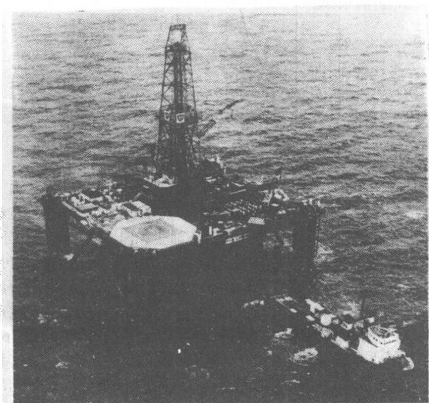
图 1-4 应用“征服”号半潜式钻井船进行海上石油勘探
