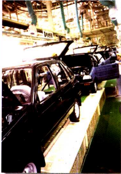
c. 由倍速链为输送元件的承托式链条输送机与移行器组成的生产自动线
