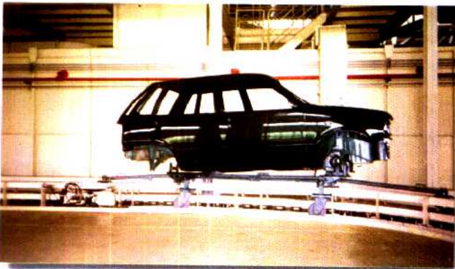
g. 输送轿车的地推式链条输送机
