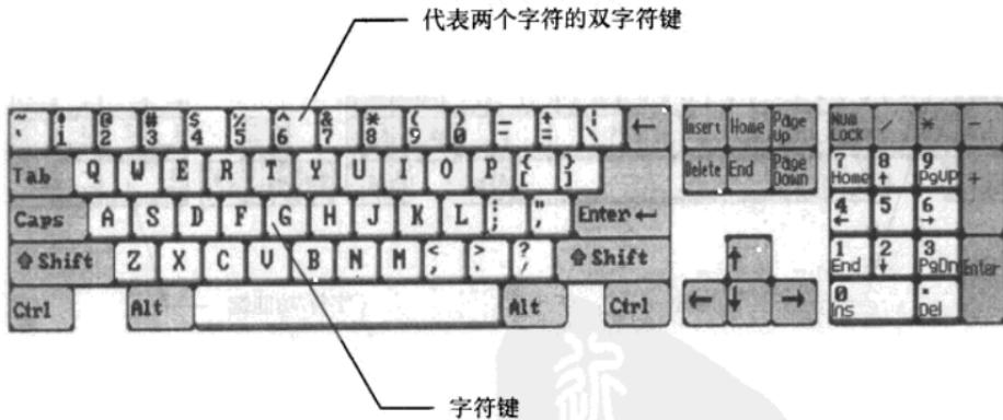
键盘上的键大致可分为两类。键帽颜色较浅、上面标有一个或两个(标有两个字符时,两个字符上下排列)字符的键,代表与所标字符相当的键,称为字符键。
