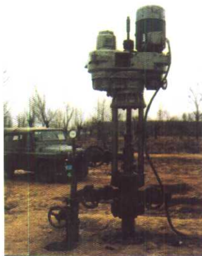
WQD型无级变速驱动装置 可配电机11 kW、15 kW、18.5 kW 转速：25 ~ 150 r/min、30 ~ 180 r/min 可配抽油杆直径为 \phi 28 、 \phi 32
