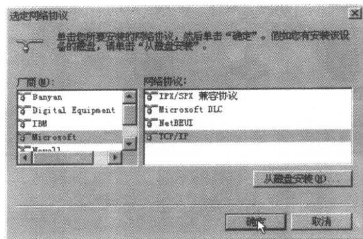
⑤ 系统会要求您放入安装盘以安装这项协议，完成后再重新开机。您可以检查是否已经安装完成。
