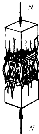
图 8-5 轴心受压短柱的破坏形态
